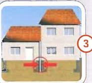
des murs ; la continuité et le recouvrement des armatures de chaînage concourants en un même nœud permettent de prévenir la rotation de plancher. Ainsi, la structure résistera mieux aux mouvements différentiels ;
