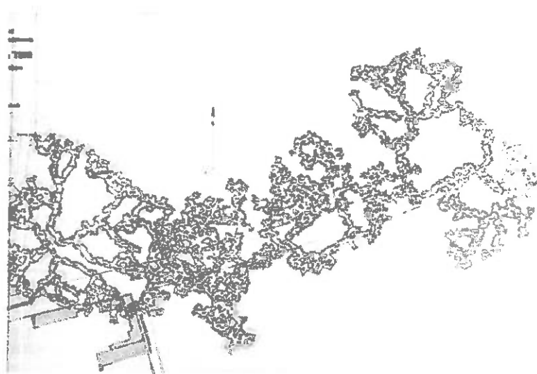
Ribécourt-la-Tour. Carrière du CD 29. On voit clairement que le carrier n'a pas hésité à exploiter largement sous la route départementale.
